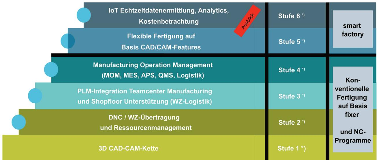
Stufenmodell der Teilefertigung
