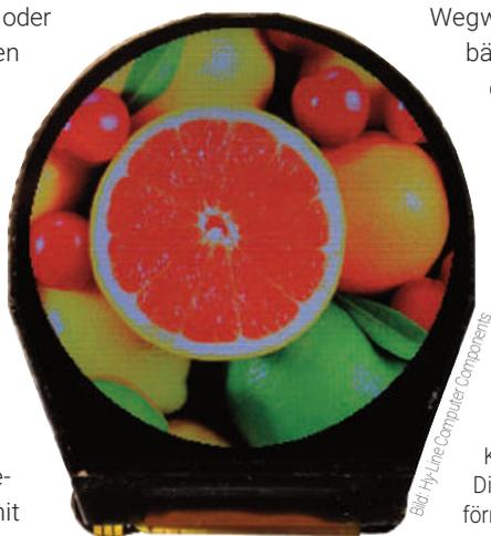
Kleinformatiges Display mit kreisförmiger Bildfläche
