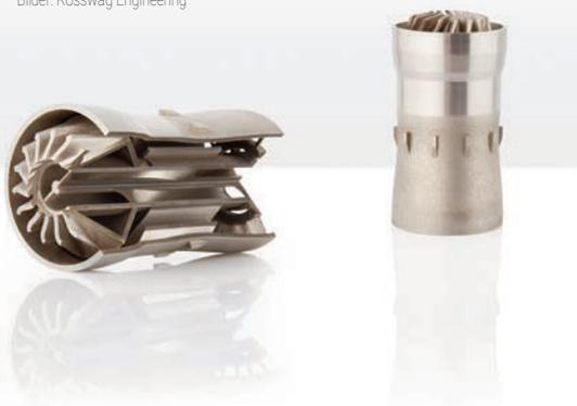
Beim selektiven Laserschmelzen wird eine dünne Schicht Metallpulver auf einer Grundplatte aufgebracht. Dann schmilzt ein Laser das Pulver an ausgewählten Stellen schichtweise zu einem Bauteil.
