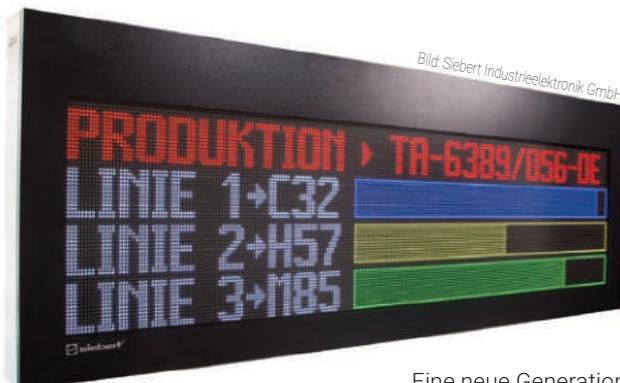
Eine neue Generation intelligenter Großanzeigen wird mit der Serie XC50 angeboten. Die Geräte besitzen eine LED-Matrix mit großem Ablesewinkel. Der integrierte PLC Connector ermöglicht die smarte Anbindung an eine Profinet-SPS, indem er die darzustellenden Informationen im Webserver der SPS abfragt, ohne dass eine Profinet-Anbindung erforderlich ist. Auch die Displays besitzen einen integrierten Webserver und können über einen Standard-Webbrowser von einem PC oder mobilen Endgerät
