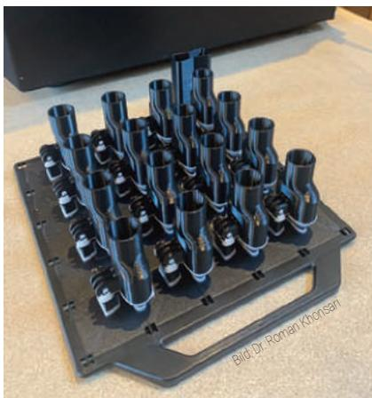
Es wird in 100er-Losen gedruckt. Danach müssen die Bauteile die Reinigung und Qualitätskontrolle überstehen.
