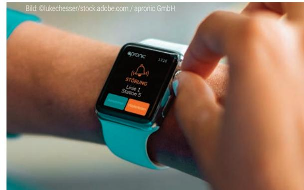
Moderne Andon-Lösungen integrieren sich in weitere Systeme und können so zum Beispiel im Falle einer Störung eine Push-Benachrichtigung auf dem Handy oder der Smartwatch des Produktionsleiters darstellen.
